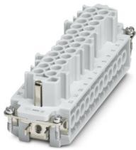
Élément de contact, nombre de pôles: 24+PE, taille: B24, nombre de raccordements par pôle: 1, Connecteur femelle, Raccordement vissé, 500 V, 16 A, 0,5 mm<sup>2</sup> ... 2,5 mm<sup>2</sup>, application: Puissance
