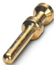
Contact à sertir, diamètre de contact: 2,5 mm, tournés, Mâle, matériau de contact: Alliage de cuivre, surface des contacts: doré, section raccordable: 0,75 mm<sup>2</sup> ... 1 mm<sup>2</sup>, AWG 18
