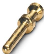
Contact à sertir, diamètre de contact: 2,5 mm, tournés, Mâle, matériau de contact: Alliage de cuivre, sans plomb, surface des contacts: doré, section raccordable: 4 mm<sup>2</sup> ... 4 mm<sup>2</sup>, AWG 12
