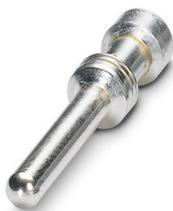
Contact à sertir, diamètre de contact: 2,5 mm, tournés, Mâle, matériau de contact: Alliage de cuivre, surface des contacts: plaqué argent, section raccordable: 2,5 mm<sup>2</sup> ... 2,5 mm<sup>2</sup>, AWG 14
