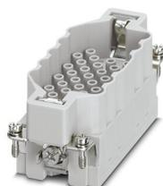
Élément de contact, nombre de pôles: 40+PE, taille: B16, nombre de raccordements par pôle: 1, Mâle, Raccordement à sertir, 500 V, 16 A, 0,5 mm<sup>2</sup> ... 4 mm<sup>2</sup>
