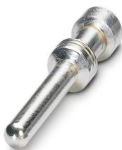
Contact à sertir, diamètre de contact: 2,5 mm, tournés, Mâle, matériau de contact: Alliage de cuivre, surface des contacts: plaqué argent, section raccordable: 1,5 mm<sup>2</sup> ... 1,5 mm<sup>2</sup>, AWG 16
