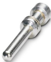
Contact à sertir, diamètre de contact: 2,5 mm, tournés, Mâle, matériau de contact: Alliage de cuivre, surface des contacts: plaqué argent, section raccordable: 0,75 mm<sup>2</sup> ... 0,75 mm<sup>2</sup>, AWG 18
