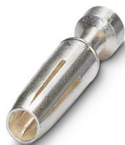
Contact à sertir, diamètre de contact: 2,5 mm, tournés, Connecteur femelle, matériau de contact: Alliage de cuivre, surface des contacts: plaqué argent, section raccordable: 1,5 mm<sup>2</sup> ... 1,5 mm<sup>2</sup>, AWG 16
