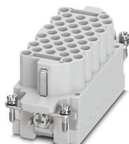
Élément de contact, nombre de pôles: 40+PE, taille: B16, nombre de raccordements par pôle: 1, Connecteur femelle, Raccordement à sertir, 500 V, 16 A, 0,5 mm<sup>2</sup> ... 4 mm<sup>2</sup>
