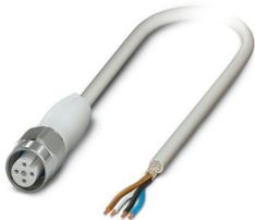
Câble pour capteurs/actionneurs, 4-pôles exempt d'halogène, blindé, extrémité libre, sur Connecteur femelle droit M12, détrompage: A, longueur de câble: 20 m, Conception hygiénique, avec molette inox
