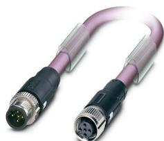
Câble préconfectionné pour bus, CANopen<sup>®</sup>, DeviceNet<sup>™</sup>, 5-pôles exempt d'halogène, blindé, connecteur mâle droit M12, détrompage: A SPEEDCONNEC, sur Connecteur femelle droit M12, détrompage: A SPEEDCONNEC, longueur de câble: 3 m
