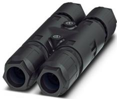
Répartiteur en H QUICKON, noir, 4 pôles + PE, 2,5mm<sup>2</sup> ... 6,0 mm<sup>2</sup> / 690 V / 40 A, pour diamètres de câble de 12 mm ... 20 mm, avec un boulon de fermeture.
