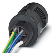
Traversée de paroi QUICKON, 4 pôles + PE, 2,5 mm<sup>2</sup> ... 6,0 mm<sup>2</sup> / 690 V / 40 A, sans écrou QUICKON, noir, filetage M25 avec 5 fils soudés de 6,0 mm<sup>2</sup>, 1,0 m de long, coupe lisse à l'extrémité.
