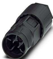
Prolongateur de câble QUICKON, avec un écrou QUICKON, noir, 4 pôles + PE, 2,5 mm<sup>2</sup>... 6,0 mm<sup>2</sup> / 690 V / 40 A, pour diamètres de câble de 12 mm ... 20 mm.
