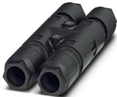
Répartiteur en H QUICKON, noir, 4 pôles + PE, 2,5mm<sup>2</sup> ... 6,0 mm<sup>2</sup> / 690 V / 40 A, pour diamètres de câble de 12 mm ... 20 mm, avec un boulon de fermeture.
