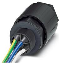
Traversée de paroi QUICKON, 4 pôles + PE, 2,5 mm<sup>2</sup> ... 6,0 mm<sup>2</sup> / 690 V / 40 A, avec écrou QUICKON, noir, pour diamètre de câble 12 mm ... 20 mm, filetage M25 avec 5 fils soudés de 6,0 mm<sup>2</sup>, 1,0 m de long, coupe lisse à l'extrémité.
