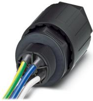
Traversée de paroi QUICKON, 4 pôles + PE, 2,5 mm<sup>2</sup> ... 6,0 mm<sup>2</sup> / 690 V / 40 A, avec écrou QUICKON, noir, pour diamètre de câble 12 mm ... 20 mm, filetage M25 avec 5 fils soudés de 6,0 mm<sup>2</sup>, 0,5 m de long, coupe lisse à l'extrémité.
