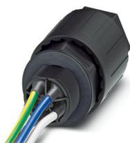
Traversée de paroi QUICKON, 4 pôles + PE, 2,5 mm<sup>2</sup> ... 6,0 mm<sup>2</sup> / 690 V / 40 A, avec écrou QUICKON, noir, pour diamètre de câble 12 mm ... 20 mm, filetage M25 avec 5 fils soudés de 6,0 mm<sup>2</sup>, 1,0 m de long, coupe lisse à l'extrémité.
