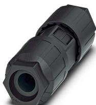
Prolongateur de câble QUICKON, noir, 4 pôles + PE, 2,5 mm<sup>2</sup> ... 6,0 mm<sup>2</sup> / 690 V / 40 A, pour diamètres de câble de 12 mm ... 20 mm.
