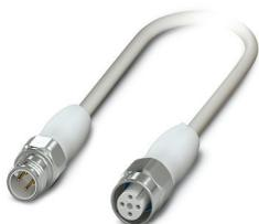
Câble pour capteurs/actionneurs, 4-pôles exempt d'halogène, connecteur mâle droit M12, détrompage: A, sur Connecteur femelle droit M12, détrompage: A, longueur de câble: 10 m, Conception hygiénique, avec molette inox, Variante client
