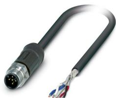
Câble préconfectionné pour bus, CANopen<sup>®</sup>, DeviceNet<sup>™</sup>, 5-pôles exempt d'halogène, blindé, connecteur mâle droit M12, détrompage: A, sur extrémité libre, longueur de câble: 5 m, pour applications extérieures, avec molette inox
