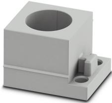
Embout de câble, petit, nombre de conducteurs: 1, version: Câble rond, fendu, diamètre extérieur du câble: 1x 13,9 mm ... 14,2 mm, matériau: SEBS (exempt d'halogène), coloris: gris, longueur: 29,5 mm, largeur: 19,5 mm, hauteur: 17 mm
