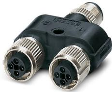
Répartiteur en Y, 4-pôles, connecteur mâle droit M12, détrompage: T, sur Connecteur femelle droit M12, détrompage: T et Connecteur femelle droit M12, détrompage: T, pour courant continu jusqu'à 12 A/63 V
