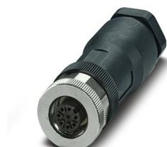
Connecteur, Universel, 8-pôles, connecteur femelle droit M12, A, Raccordement vissé, matériau de la molette: Laiton, nickelé, presse-étoupe Pg11, diamètre extérieur du câble 8 mm ... 10 mm
