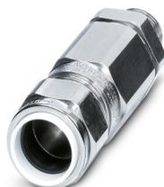
Presse-étoupe, matériau du raccordement vissé: Acier inoxydable 316L, application: Ex, diamètre extérieur du câble 9,5 mm ... 15,9 mm, blindage: oui, filetage de raccordement: M20 x 1,5, coloris: argenté
