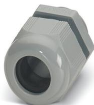
Presse-étoupe, matériau du raccordement vissé: PA, diamètre extérieur du câble 30 mm ... 38 mm, blindage: non, filetage de raccordement: Pg42, coloris: gris argent RAL 7001
