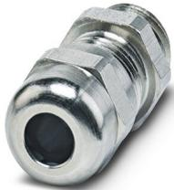
Presse-étoupe, matériau du raccordement vissé: Laiton, nickelé, diamètre extérieur du câble 4 mm ... 6,5 mm, blindage: oui, filetage de raccordement: M12 x 1,5, coloris: argenté, avec joint torique
