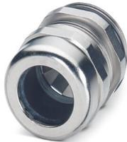
Presse-étoupe, matériau du raccordement vissé: Laiton, nickelé, diamètre extérieur du câble 5 mm ... 9 mm, blindage: oui, filetage de raccordement: M16 x 1,5, coloris: argenté, avec joint torique
