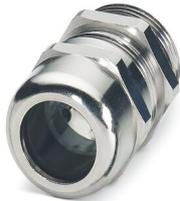
Presse-étoupe, matériau du raccordement vissé: Laiton, nickelé, diamètre extérieur du câble 13 mm ... 18 mm, blindage: oui, filetage de raccordement: Pg21, coloris: argenté, avec joint torique
