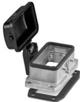
Embase B10, pour étrier transversal, matériau: Aluminium coulé sous pression, résistant à l'eau de mer, matériau du couvercle de protection: PC, hauteur: 30,5 mm, presse-étoupe: sans, capot de protection: oui, Standard, avec joint plat
