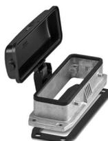
Embase B24, pour étrier transversal, matériau: Aluminium coulé sous pression, résistant à l'eau de mer, matériau du couvercle de protection: PC, hauteur: 30,5 mm, presse-étoupe: sans, capot de protection: oui, Standard, avec joint plat
