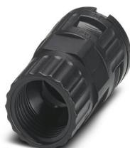
Adaptateur pour gaines annelées, avec filetage intérieur, pour le raccordement de gaines annelées à des raccords vissés HEAVYCONNEC EVO M20 en plastique ou à un boîtier en plastique ADVANCE M20, droit, noir, IP66.
