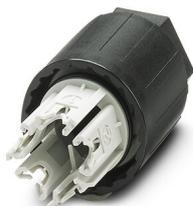
Écrou QUICKON, noir, 4 pôles + PE, 2,5 mm<sup>2</sup> ... 6,0mm<sup>2</sup> / 690 V / 40 A, pour câbles d'un diamètre de 12 mm ... 20 mm.
