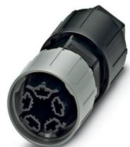
Connecteur, Raccordement IDC, nombre de pôles: 4+PE, 690 V, 40 A, noir, avec écrou QUICKON, diamètre extérieur du câble: 9 mm ... 14 mm
