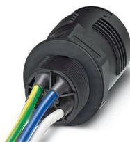
Traversée de paroi QUICKON, 4 pôles + PE, 2,5 mm<sup>2</sup> ... 6,0 mm<sup>2</sup> / 690 V / 40 A, sans écrou QUICKON, noir, filetage M25 avec 5 fils soudés de 6,0 mm<sup>2</sup>, 0,5 m de long, coupe lisse à l'extrémité.
