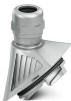
Presse-étoupe métallique EVO avec fermeture à baïonnette, série B, taille M25, diamètre de câble 11-16 mm
