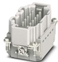
Élément de contact, nombre de pôles: 10+PE, taille: B10, nombre de raccordements par pôle: 1, Mâle, Raccordement Push-in, 500 V, 16 A, 0,14 mm<sup>2</sup> ... 2,5 mm<sup>2</sup>, application: Puissance
