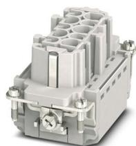
Élément de contact, nombre de pôles: 10+PE, taille: B10, nombre de raccordements par pôle: 1, Connecteur femelle, Raccordement Push-in, 500 V, 16 A, 0,14 mm<sup>2</sup> ... 2,5 mm<sup>2</sup>, application: Puissance
