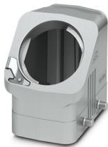
Capot passe-câble HEAVYCONNEC EVO, version CEM, sans revêtement par pulvérisation, avec bride à baïonnette pour le raccordement vissé EVO, B10, pour verrouillage transversal, hauteur 64 mm, sans raccordement vissé EVO.
