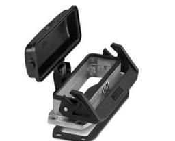
Embase B24, avec étrier longitudinal, matériau: Aluminium coulé sous pression, résistant à l'eau de mer, matériau du couvercle de protection: PC, hauteur: 30,5 mm, presse-étoupe: sans, capot de protection: oui, Standard, avec joint plat
