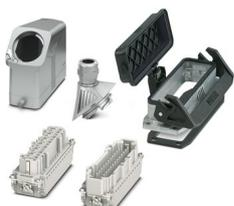
Kit de connecteurs EVO, série B24, boîtier métallique, comprenant un capot passe-câble 1411473, une embase 1411330, un raccordement vissé EVO 1411440, jeu de contacts mâles 1407736, jeu de contacts femelles 1407735
