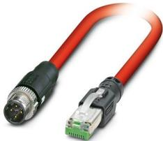
Câble de réseau, Sercos CAT5 (100 Mbit/s), 4-pôles, blindé, connecteur mâle droit M12 SPEEDCONNEC, détrompage: D / IP67, sur connecteur mâle droit RJ45 / IP20, longueur de câble: 2 m
