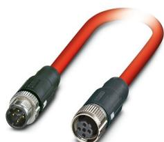
Câble de réseau, Sercos CAT5 (100 Mbit/s), 4-pôles, blindé, connecteur mâle droit M12, détrompage: D SPEEDCONNEC / IP67, sur Connecteur femelle droit M12, détrompage: D SPEEDCONNEC / IP67, longueur de câble: 10 m
