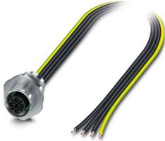
Embases paroi avant, Puissance, 4-pôles, connecteur femelle, droit, M12-Standard, détrompage: S, sur extrémité libre, Montage sur face avant, M16 x 1,5, Cordons individuels, longueur de câble: 0,5 m, 1,31 mm<sup>2</sup>, Tresse de connexion UL/cUL, Produit de remplacement selon RoHS II sans exception 6c (Pb < 0,1 %) référence : 1238901
