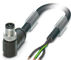
Conducteur de puissance, 3-pôles, connecteur mâle coudé M12, détrompage: S, sur extrémité libre, longueur de câble: 1 m, pour courant alternatif jusqu'à 16 A/250 V
