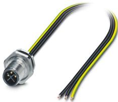
Connecteur d'appareil face arrière, Universel, 3-pôles, Connecteur mâle, droit, M12-Standard, détrompage: S, sur extrémité libre, Montage face arrière, M16 x 1,5, Cordons individuels, longueur de câble: 0,5 m, 1,31 mm<sup>2</sup>, Tresse de connexion UL/cUL, Produit de remplacement selon RoHS II sans exception 6c (Pb < 0,1 %) référence : 1238907
