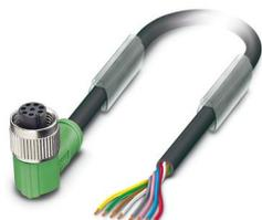
Câble pour capteurs/actionneurs, 8-pôles, PUR exempt d'halogène, gris-noir RAL 7021, extrémité libre, sur Connecteur femelle coudé M12 SPEEDCONNec, détrompage: A, longueur de câble: 5 m
