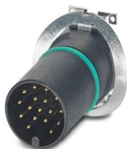
Jeu d'échantillon, 17-pôles, Connecteur mâle, droit, M12, détrompage: A, Montage circuits imprimés, SMD, Produit de remplacement selon RoHS II sans exception 6c (Pb < 0,1 %) référence : 1239214
