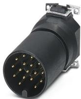
Porta-contatos, 17-pôles, Connecteur mâle, droit, M12, détrompage: A, Montage circuits imprimés, Par refusion SMD, Produit de remplacement selon RoHS II sans exception 6c (Pb < 0,1 %) référence : 1238951
