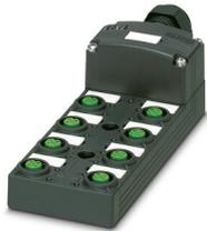
Boîtier répartiteur, application : Standard, type de raccordement: Connecteur femelle M12 SPEEDCONNEC Plastique, nombre de prises: 8, nombre de pôles: 5, détrompage: A, affectation des prises: double, affichage d'état: Oui, pnp; racc. câble multicond.: Raccordement Push-in / Raccordement à ressort 180°, blindage: non
