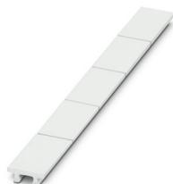
Repérage ZB d'étiquettes pour contacteur, Rubans, blanc, vierge, repérable avec : CMS-P1-PLOTTER, type de montage: encliquetage dans la rainure de repérage plate, surface utile: 17,5 x 9 mm, Nombre d'étiquettes: 5
