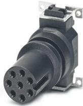
Porta-contatos, 8-pôles, connecteur femelle, droit, M8, détrompage: A, Montage circuits imprimés, Par refusion SMD, Produit de remplacement selon RoHS II sans exception 6c (Pb < 0,1 %) référence : 1238978
