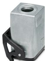
Boîtier prolongateur B6, avec étrier longitudinal, matériau: Aluminium coulé sous pression, résistant à l'eau de mer, nombre de sorties: 1, droit, 1x M20, hauteur: 73 mm, presse-étoupe: sans, Standard
