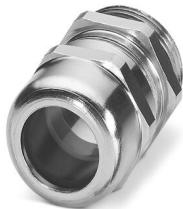
Presse-étoupe, matériau du raccordement vissé: Laiton, nickelé, diamètre extérieur du câble 6 mm ... 12 mm, blindage: non, filetage de raccordement: Pg13,5, coloris: argenté, avec joint torique
