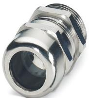
Presse-étoupe, matériau du raccordement vissé: Laiton, nickelé, diamètre extérieur du câble 6 mm ... 12 mm, blindage: oui, filetage de raccordement: Pg13,5, coloris: argenté, avec joint torique
