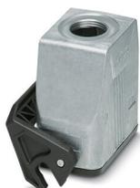
Boîtier prolongateur B10, avec étrier longitudinal, matériau: Aluminium coulé sous pression, résistant à l'eau de mer, nombre de sorties: 1, droit, 1x M20, hauteur: 73 mm, presse-étoupe: sans, Standard
