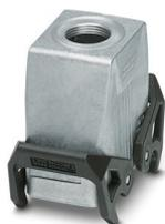
Capot passe-câble B10, avec étrier transversal, matériau: Aluminium coulé sous pression, résistant à l'eau de mer, nombre de sorties: 1, droit, 1x Pg29, hauteur: 72 mm, presse-étoupe: sans, Standard
