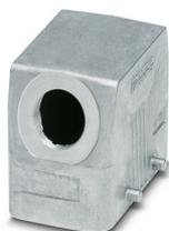
Capot passe-câble B10, pour étrier transversal, matériau: Aluminium coulé sous pression, résistant à l'eau de mer, nombre de sorties: 1, latérale, 1x Pg16, hauteur: 57 mm, presse-étoupe: sans, Standard
