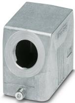
Capot passe-câble B10, pour étrier longitudinal, matériau: Aluminium coulé sous pression, résistant à l'eau de mer, nombre de sorties: 1, latérale, 1x M25, hauteur: 57 mm, presse-étoupe: sans, Standard
