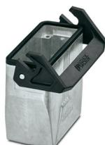
Boîtier prolongateur B16, avec étrier longitudinal, matériau: Aluminium coulé sous pression, résistant à l'eau de mer, nombre de sorties: 1, droit, 1x M25, hauteur: 79 mm, presse-étoupe: sans, Standard
