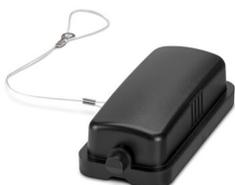
Capot de protection B16, pour étrier longitudinal, matériau du couvercle de protection: PC, hauteur: 26,3 mm, joint: non
