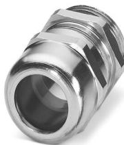
Presse-étoupe, matériau du raccordement vissé: Laiton, nickelé, diamètre extérieur du câble 13 mm ... 18 mm, blindage: non, filetage de raccordement: Pg21, coloris: argenté, avec joint torique
