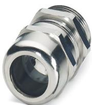
Presse-étoupe, matériau du raccordement vissé: Laiton, nickelé, diamètre extérieur du câble 13 mm ... 18 mm, blindage: oui, filetage de raccordement: Pg21, coloris: argenté, avec joint torique
