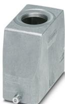
Capot passe-câble B16, pour étrier longitudinal, matériau: Aluminium coulé sous pression, résistant à l'eau de mer, nombre de sorties: 1, droit, 1x Pg29, hauteur: 76 mm, presse-étoupe: sans, Standard
