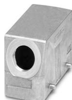
Capot passe-câble B16, pour étrier transversal, matériau: Aluminium coulé sous pression, résistant à l'eau de mer, nombre de sorties: 1, latérale, 1x Pg16, hauteur: 60 mm, presse-étoupe: sans, Standard
