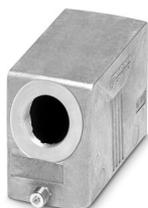
Capot passe-câble B16, pour étrier longitudinal, matériau: Aluminium coulé sous pression, résistant à l'eau de mer, nombre de sorties: 1, latérale, 1x Pg21, hauteur: 60 mm, presse-étoupe: sans, Standard
