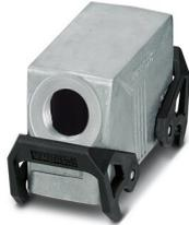
Capot passe-câble B16, avec étrier transversal, matériau: Aluminium coulé sous pression, résistant à l'eau de mer, nombre de sorties: 1, latérale, 1x M25, hauteur: 60 mm, presse-étoupe: sans, Standard
