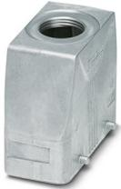
Capot passe-câble B24, pour étrier transversal, matériau: Aluminium coulé sous pression, résistant à l'eau de mer, nombre de sorties: 1, droit, 1x Pg21, hauteur: 76 mm, presse-étoupe: sans, Standard
