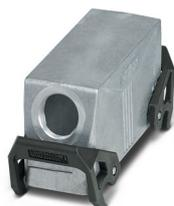
Capot passe-câble B24, avec étrier transversal, matériau: Aluminium coulé sous pression, résistant à l'eau de mer, nombre de sorties: 1, latérale, 1x M25, hauteur: 60 mm, presse-étoupe: sans, Standard
